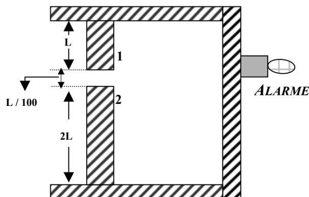
O alarme é ativado quando as barras 1 e 2 fazem contato. Considere: **Coefficiente de dilatação linear do bloco 1 =  $2 \times 10^{-4} (^{\circ}\text{C})^{-1}$**  e **Coefficiente de dilatação linear do bloco 2 =  $1.5 \times 10^{-4} (^{\circ}\text{C})^{-1}$** , para determinar o incremento de temperatura que os alunos da Física da UNIFAP devem fornecer para ativar o alarme.
